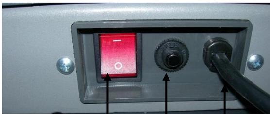
電源スイッチ ブレーカー 電源コード
