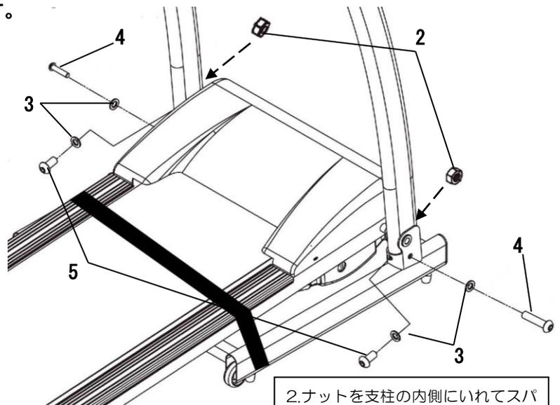
2.ナットを支柱の内側にいれてスパナで押さえながら 4.ボルト(長)をレンチでまわして固定します。
