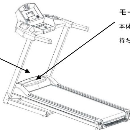
本体の前側からプラスチックのカバー下側を持ち上げていただくと取り外せます。
