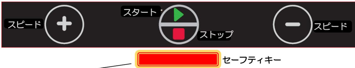
セーフティキーについて：本機は安全のため速度についていけない等になられた場合に「セーフティキー」がはずれ、パネルに“—”が表示され、ベルトが止まるようになっています。もう一度「セーフティキー」を差込みますと、パネルに“0”が表示されます。
