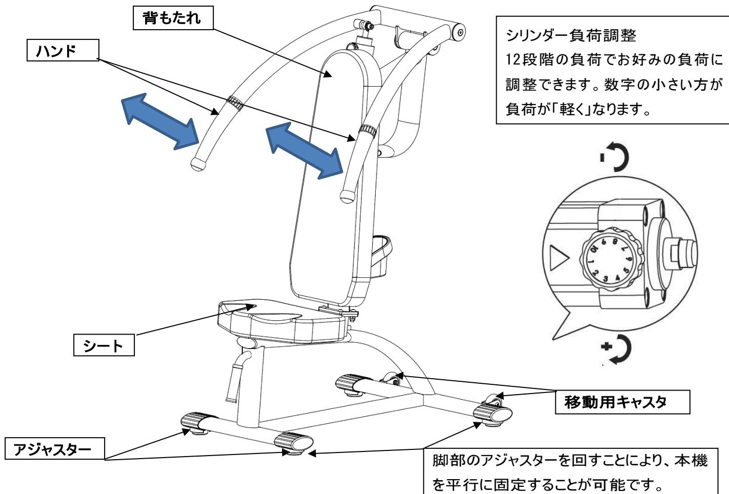
**\*ご注意ください！** 激しく運動を行いますとシリンダーの温度が上昇し故障の原因になりますので、運動を行う際には気をつけて下さい。
