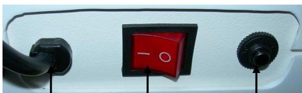
電源コード 電源スイッチ ブレーカー
