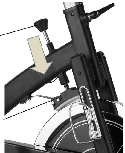
**ストッパー部は消耗品です。負荷調整・緊急停止の効きが悪く感じたらすぐに交換してください。**
